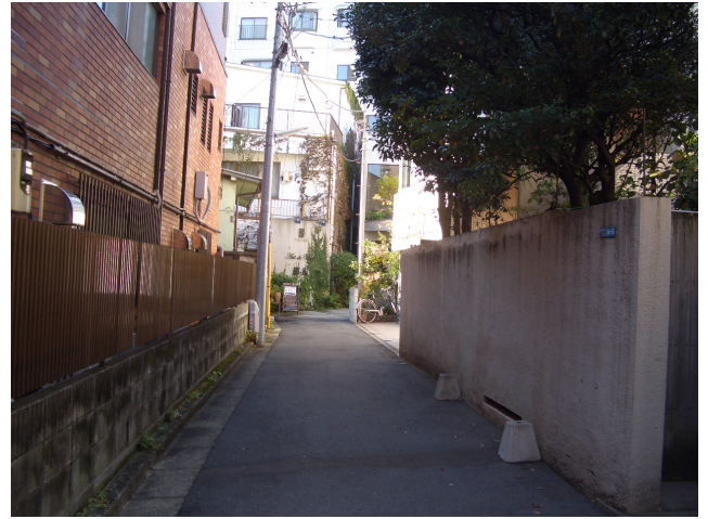
50 先は行き止り。塀はコンクリートブロックであるから倒壊し、避難を妨げる恐れもある。
