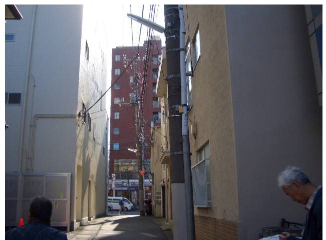
36 電柱傾倒。電柱の存在は平時においても道路の有効幅を小さくしている。園児等避難者と救助隊が行き交う場面で妨げとなる。
